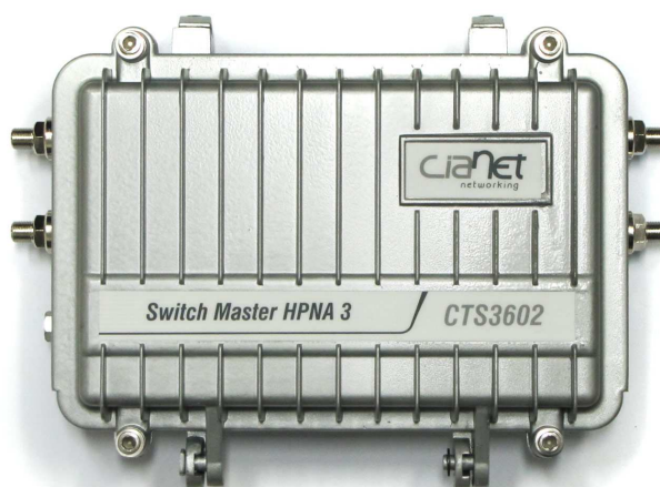
Figura 2.3-1: Vista externa do Switch Master HPNA 3 Outdoor.
