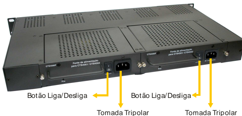
Figura 2.4-1: Vista do painel traseiro do Channel Bank.
